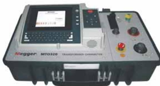
По завершении тестирования, прибор автоматически размагничивает трансформатор. Прибор поставляется с компьютерной программой PowerDB (в версии LITE), которая позволяет пользователю анализировать данные и тренды результатов.
