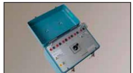
Блок коммутации для трансформаторов тока
